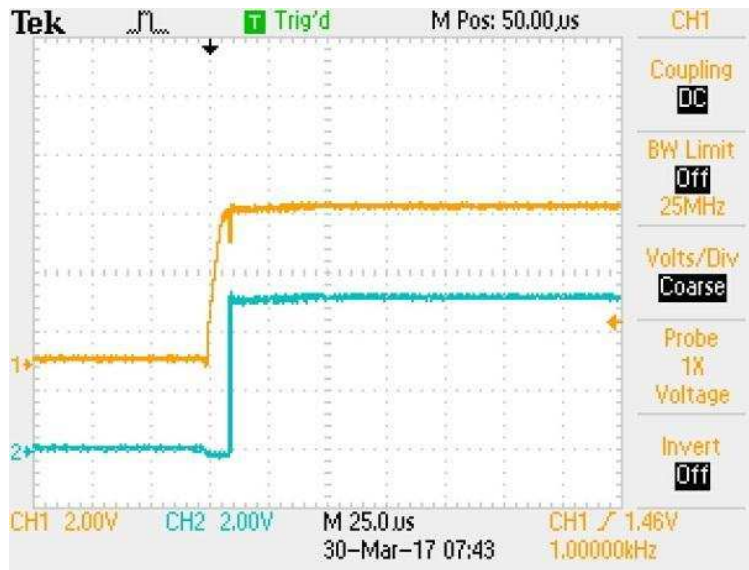
Gambar 7. Gelombang PWM dengan dead band
