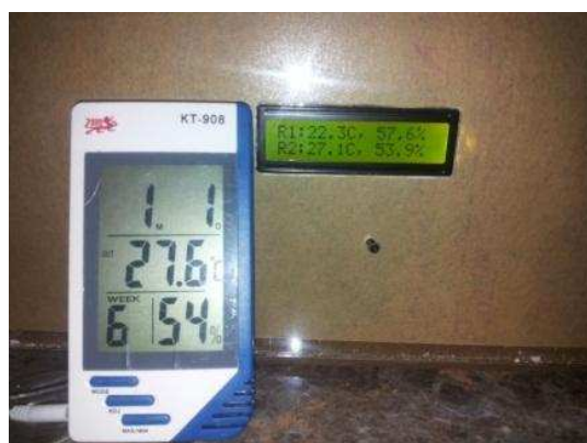
GAMBAR 3. DATA TAMPILAN LCD DAN ALAT PEMBANDING HYGROMETER
