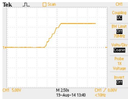
Gambar 9 Respon Transien Konverter Tanpa Kontroler Proporsional
