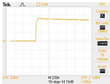
Gambar 10 Respon Transien Konverter Dengan Kontroler Proporsional
