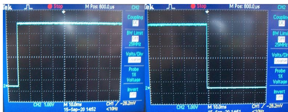
Gambar 7. Bentuk gelombang PWM
