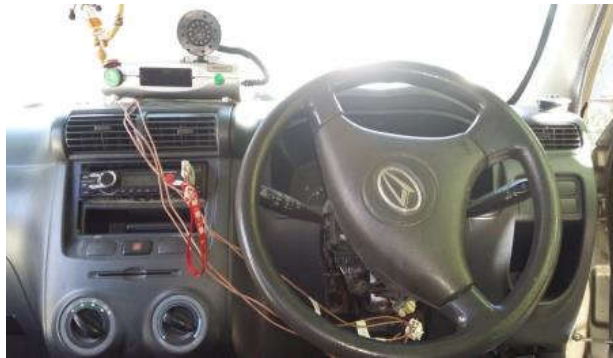
GAMBAR 11 PENEMPATAN ALAT ALCOHOL DETECTOR PADA KENDARAAN
