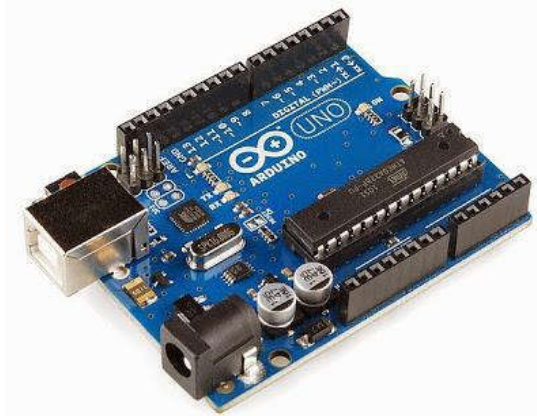
GAMBAR 2 PAPAN ARDUINO UNO (KINANTI. 2016 : 8)
