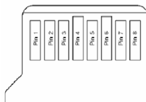
GAMBAR 6 PIN KONEKTOR KARTU MEMORI MICRO SD (PURWANINGSIH. 2015 : 32)
